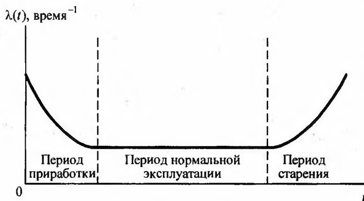
Рисунок 4.1 – Характерное изменение интенсивности потока отказов
