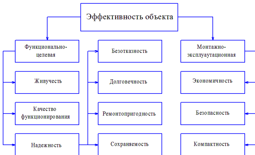
Рисунок 2.2 – Структура понятия эффективности технического объекта
