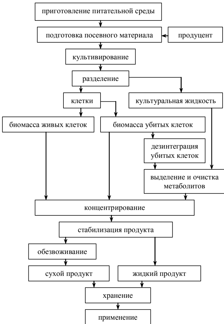
Рисунок 2 – Принципиальная биотехнологическая схема производства продуктов микробного синтеза
