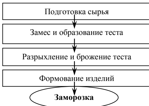
Рисунок 1 – Обобщенная схема производства замороженных хлебобулочных изделий
