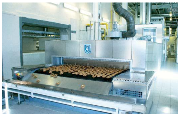
Рисунок И.2 – Комплексно-механизированная бараночная линия с печью J4 (Чехия)
