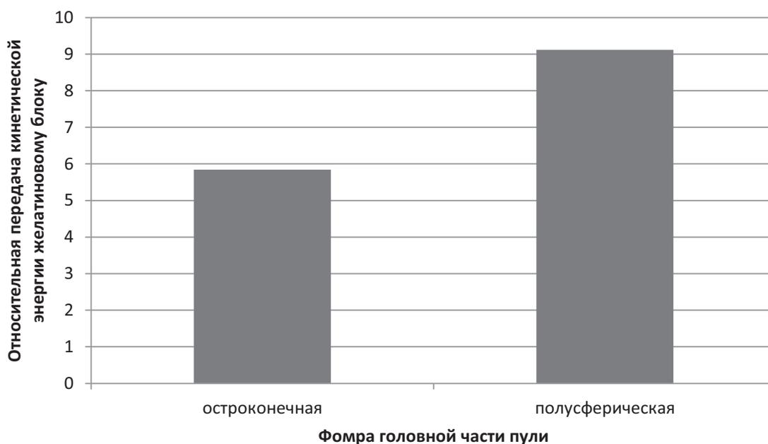
Рисунок 60 – Сравнительная характеристика относительной передачи кинетической энергии желатиновому блоку при проникании остроконечной и полусферической формами головной части пули при скорости встречи 800 м/с
