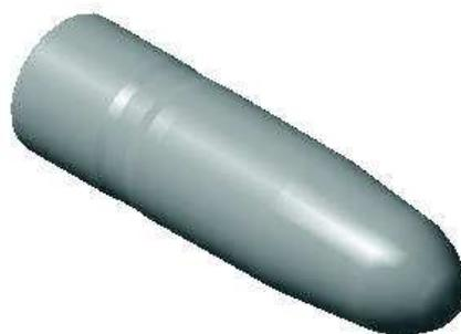
Рисунок 48 – Пуля с полусферической формой головной части
